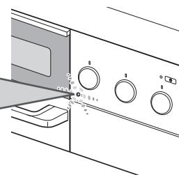
電池交換サインが点灯しているときに点火操作すると、コンロ・グリルの液晶表示部に乾電池交換のお知らせが表示されます。点滅のときには表示は出ません。(この表示は、操作ボタンを戻すと解除できます。)
