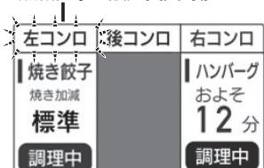
※操作後、他のコンロの設定を変更するか、一定時間が経過すると、点滅表示は表示されなくなります。
